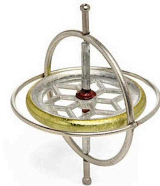
Figura 3.2.8-1 Ejemplo de giróscopo
