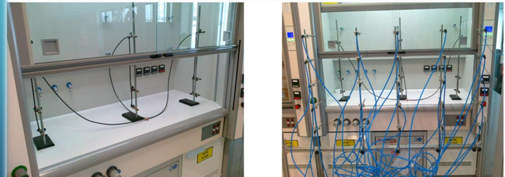
Fig. 13 (a) –Posición de los inyectores dentro de la vitrina y 13 (b) Entramado de sondas de muestreo en el plano externo de la guillotina
